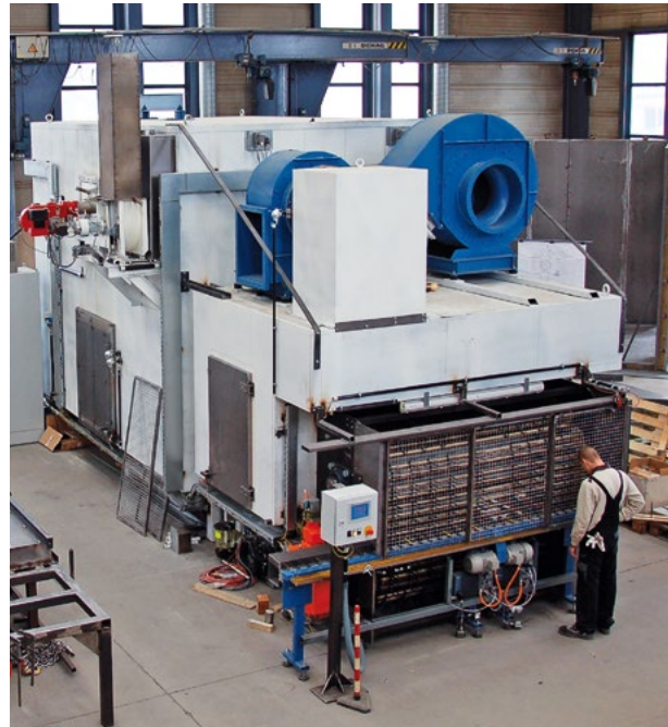
Durchlaufofen der Firma REINHARDT zum Anlassen von Metallteilen.
