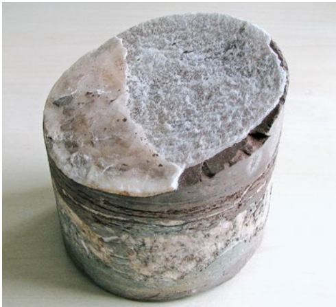
Bohrer und unten ein Bohrkern aus dem Gipskeuper mit Anhydrit (Mitte) und Gips (Kluftfläche oben).
