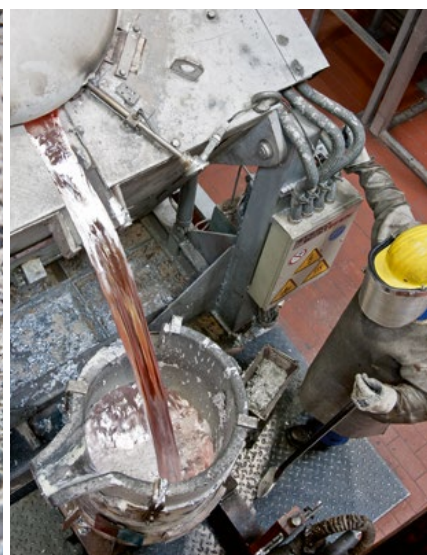
Das Werk 2 von Ketterer Druckguss am Niegenhirschwald in Furtwangen. Wo die Fassade mit grau-schwarzem holländischem Klinker verkleidet ist, wird bei 750 Grad das Aluminium geschmolzen.
